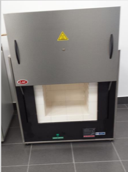
Piec laboratoryjny LAC HT 40 AL stosowany w laboratoriach do testowania różnych próbek w trakcie obróbki cieplnej
